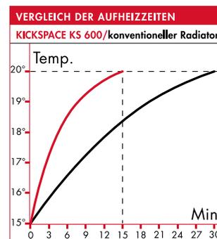
ca. 12 m<sup>2</sup> großen Raum von 15 °C Ausgangstemperatur auf 20 °C Wohlfühltemperatur aufzuheizen. Schnelles und wirkungsvolles Aufheizen ist eine der starken **Kickspace**-Seiten, und die Steuerung komfortabler Wärme je
