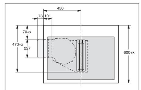
X = Maß, um das die Arbeitsplattentiefe größer ist als 600 mm. Dieses entfällt, wenn die Arbeitsplattentiefe genau 600 mm entspricht.
