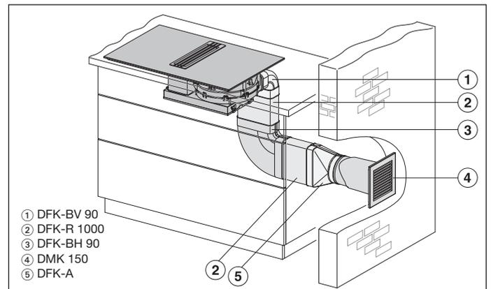
In der Auslieferung ab Werk befindet sich der Gebläsestutzen nach hinten rechts gerichtet. Die Ausblasrichtung kann je nach Bedarf geändert werden, indem der Gebläsestutzen nach seitlich rechts oder das gesamte Gebläse nach seitlich links gedreht wird.
