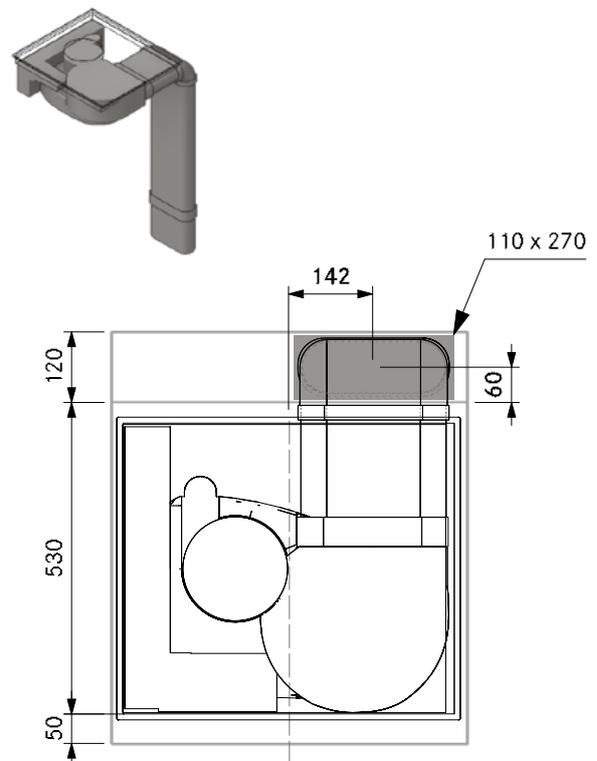
**Mindestmaß Kernbohrung PURSA mit Flachkanal EF750, Übergangsstück gerade EFRG (Zeile):**
