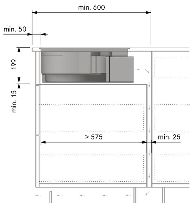
Um eine optimale Abzugsleistung sicherstellen zu können, muss für die Luftrückführung eine Rückströmöffnung von mindestens 500 cm<sup>2</sup> gewährleistet sein.
