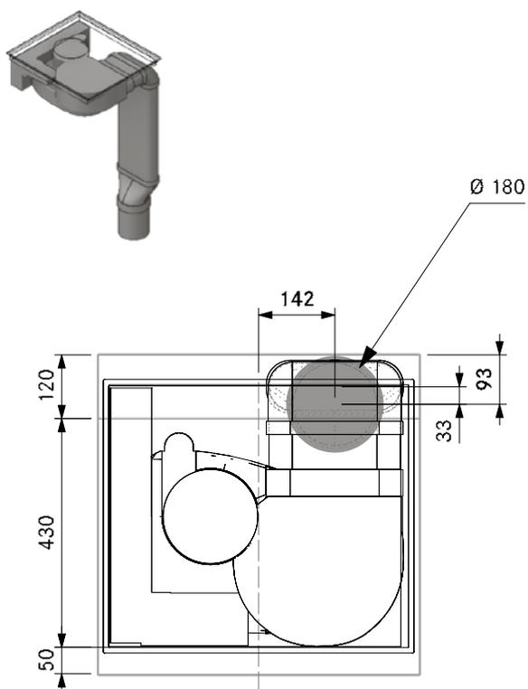
**Mindestmaß Kernbohrung PURSA mit Flachkanal EF750, Übergangsstück gerade EFRG (Insel):**
