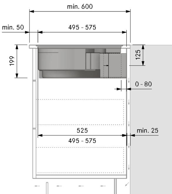
**Einbauschritt PURSU mit reversiblen Zwischenboden (Insel):**
