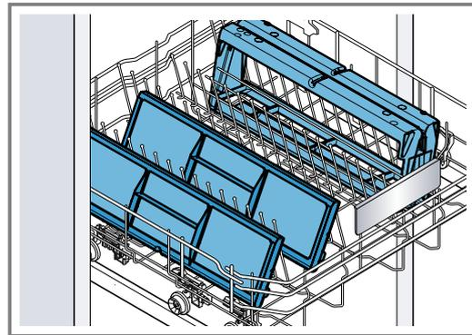
Stark verschmutzte Fettfilter nicht mit Geschirr reinigen.
