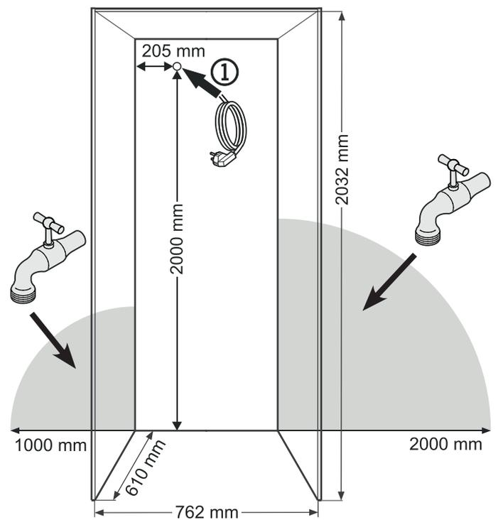
① In diesem Bereich kommt die Netzzuleitung aus der Rückseite des Gerätes.
