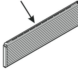
Diese Öffnung darf nicht abgedeckt werden.
