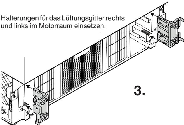
4. Die Vorderkante der Winkel ist bündig mit der Vorderseite des Lüftungsgitters. Die Halterungen entsprechend einstellen.
