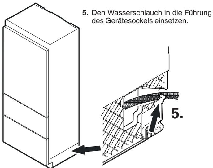
5. Den Wasserschlauch in die Führung des Gerätesockels einsetzen.
