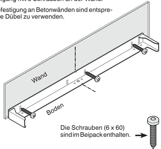
Befestigung mit 3 Schrauben am Boden.
