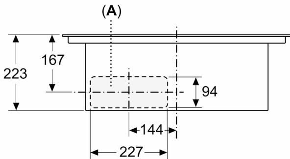
A: Direkt an der Rückseite angeschlossen
