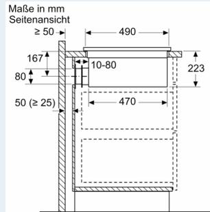
Bei der Installation direkt an einer nicht isolierten Außenwand ( $\mu \geq 0.5 \text{ W/m}^2 \cdot \text{°C}$ ) empfehlen wir die Verwendung von Konfigurationen mit teilweise oder vollständig kanalisierter Rezirkulation.
